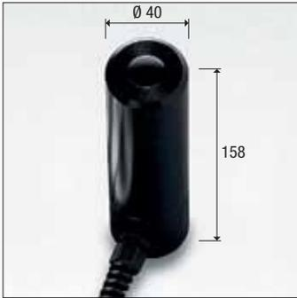
**LP 9021 LUM2:** Sonda per misure di **LUMINANZA**, misura nel campo da 1 a  $1999 \cdot 10^3$  cd/m<sup>2</sup>. Angolo di misura 2°. Filtro CIE per la correzione della risposta secondo CIE n° 69 - UNI 11142
