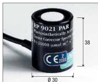
**LP 9021 PAR:** Sonda quanto-radiometrica per la misura del flusso di fotoni nel campo della clorofilla PAR (photo synthetically Active Radiation 400nm...700nm) misure in μmol m<sup>-2</sup>s<sup>-1</sup>, diffusori per la correzione del coseno.
