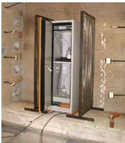
Armadio CHEMISAFE® FIREMY11 PRIMA della prova di resistenza al fuoco
