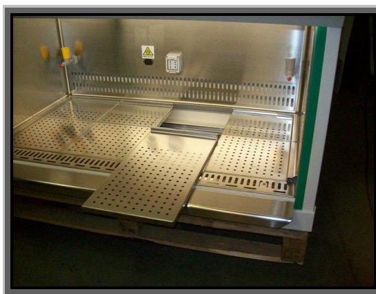
Piani di lavoro forati removibili e autoclavabili con vasca di raccolta liquidi sottostante
