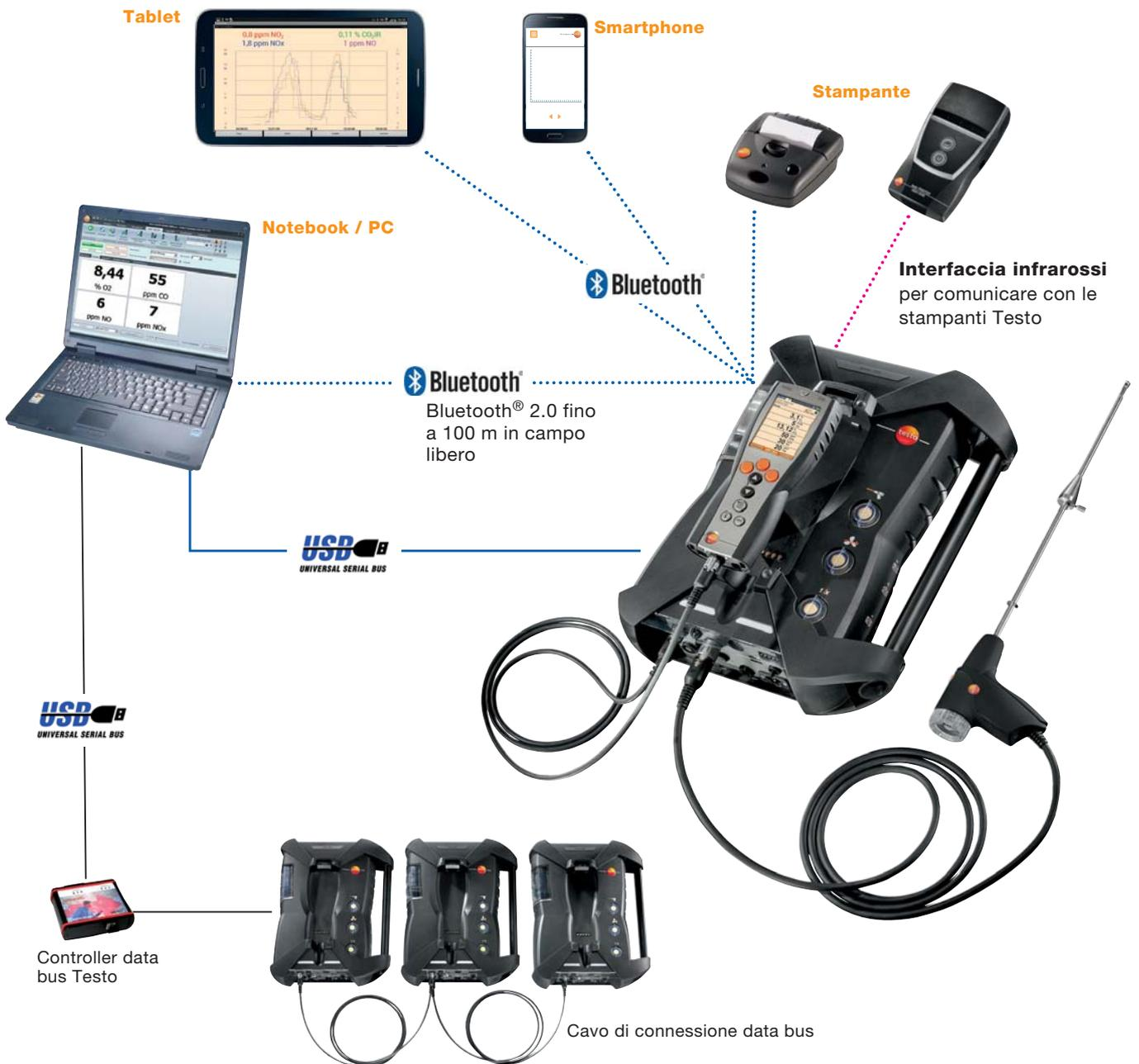
**Data bus Testo:** con cavo lungo fino a 800 m, per il funzionamento simultaneo di max. 16 unità di analisi. Controllo tramite PC, controller data bus Testo o unità di controllo.
