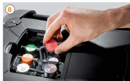
**B | Unità di analisi:** con sensori antiurto, pompe, elettronica di analisi e memoria
