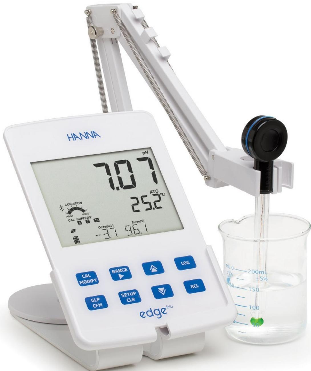
HI11102 HALO è un rivoluzionario elettrodo pH dotato di tecnologia Bluetooth (Bluetooth 4.0), la tecnologia senza fili con un design specifico. Questo elettrodo è dotato di molte caratteristiche che lo rendono ideale per l'uso in laboratorio fra le quali il vetro per usi generali (GP), punta sferica, sensore di temperatura integrato, corpo in vetro, sistema di riferimento a doppia giunzione con elettrolita in gel libero da argento.
