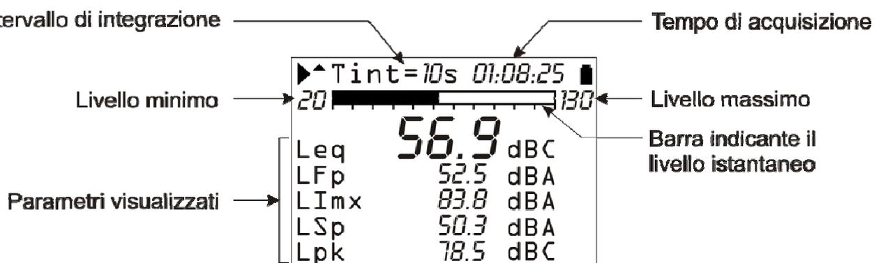
Fig. 11 - Descrizione del display in modalità SLM
