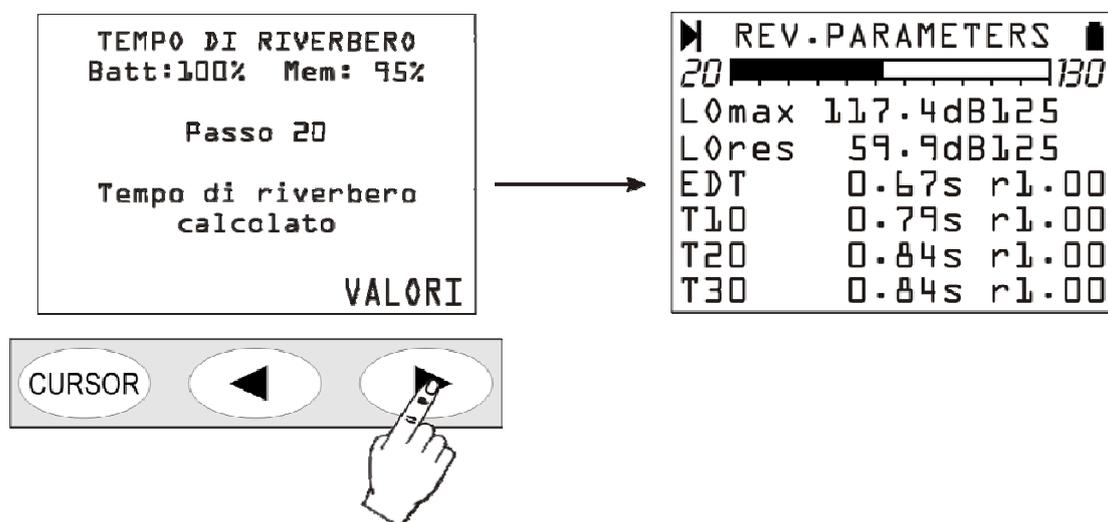
Dall'alto in basso sono riportati il livello massimo di pressione sonora per banda d'ottava raggiunto dalla sorgente di rumore (LO max), il livello di pressione sonora per banda d'ottava del rumore di fondo (LO res), il tempo di primo decadimento EDT e le tre stime del tempo di riverbero  $T_{10}$ ,  $T_{20}$  e  $T_{30}$  ciascuno con il relativo coefficiente di correlazione "r".
