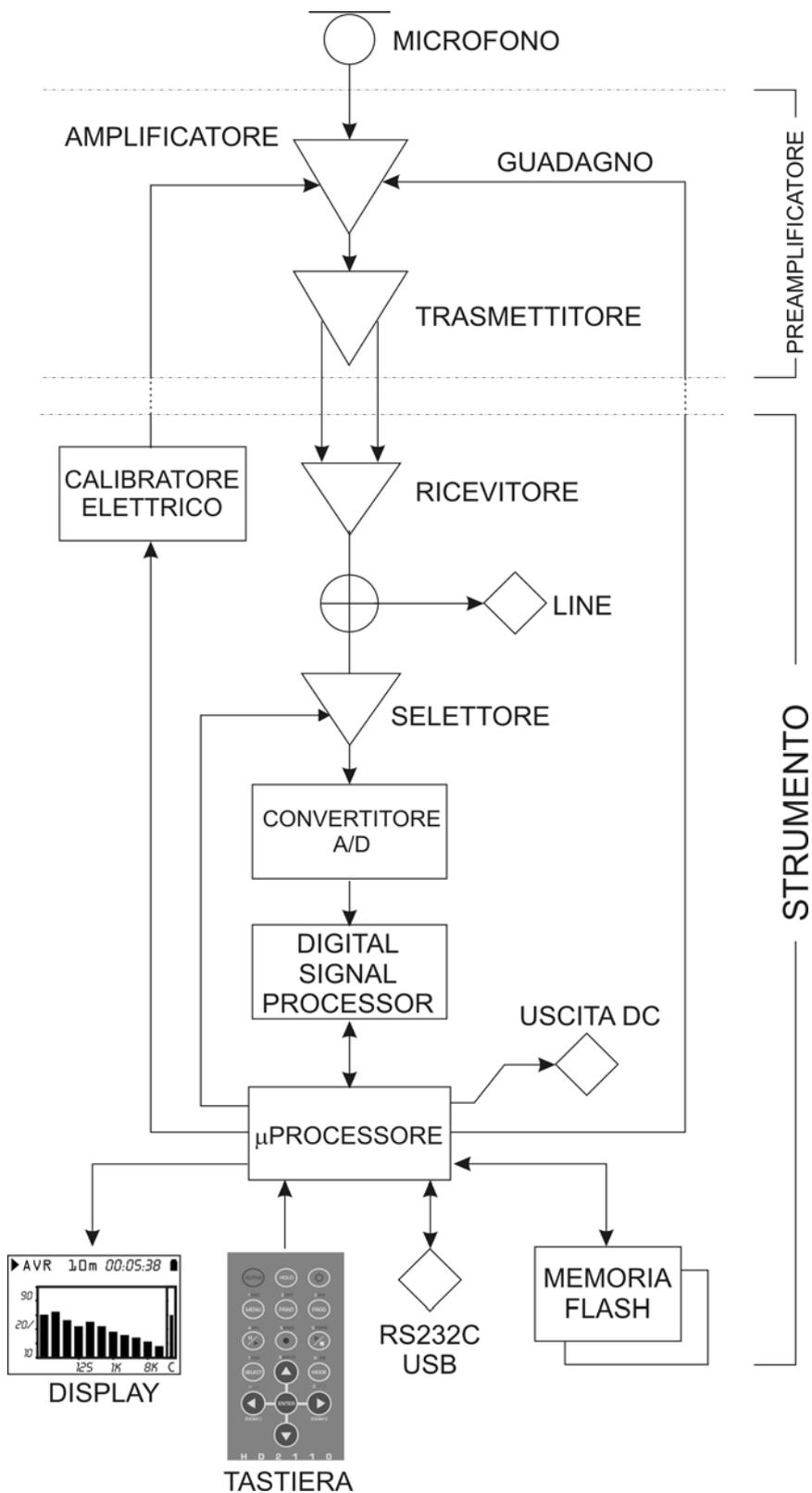
**Fig. 2 - Schema a blocchi dello strumento**
