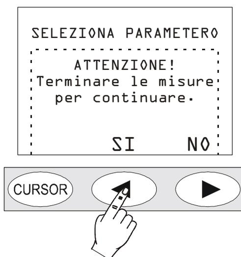
Premendo SI, è possibile poi spegnere lo strumento con il tasto ON/OFF.
