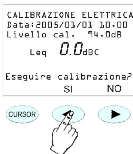
Nella schermata compaiono la data e l'ora dell'ultima calibrazione ed il livello sonoro del calibratore così com'è impostato a menu (parametro MENU >> Calibrazione >> Livello Calibratore). Se si risponde affermativamente alla richiesta di procedere viene avviato il programma di calibrazione scelto.
