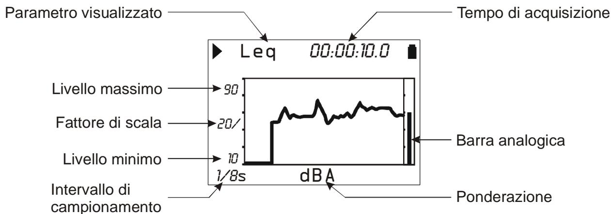
**Fig. 12 - Descrizione del display in modalità Profilo**
