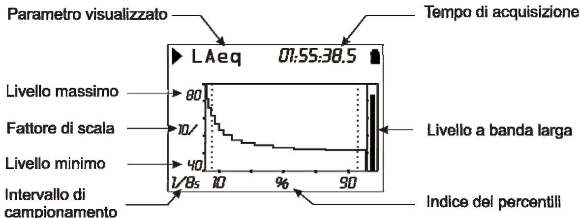
Fig. 25 - Descrizione del display in modalità Livelli Percentili
