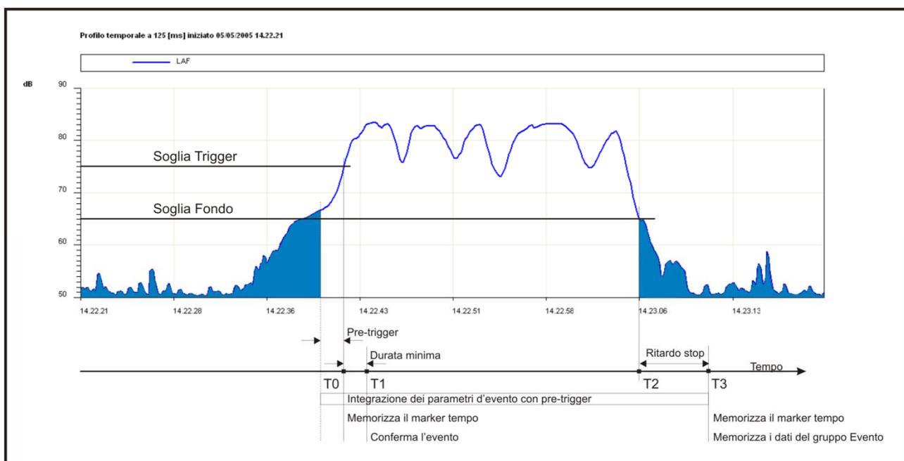
**Fig. 26 - Descrizione dei parametri del trigger d'evento**
