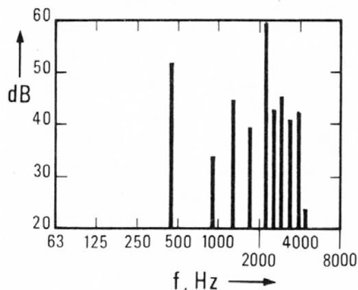
L'analisi di spettro, in aggiunta alla misura del livello sonoro a banda larga (ad esempio con ponderazione A), fornisce informazioni quali la possibile "concentrazione" del rumore in alcune frequenze (*componenti tonali*) oppure permette di determinare il *livello di distorsione*.
