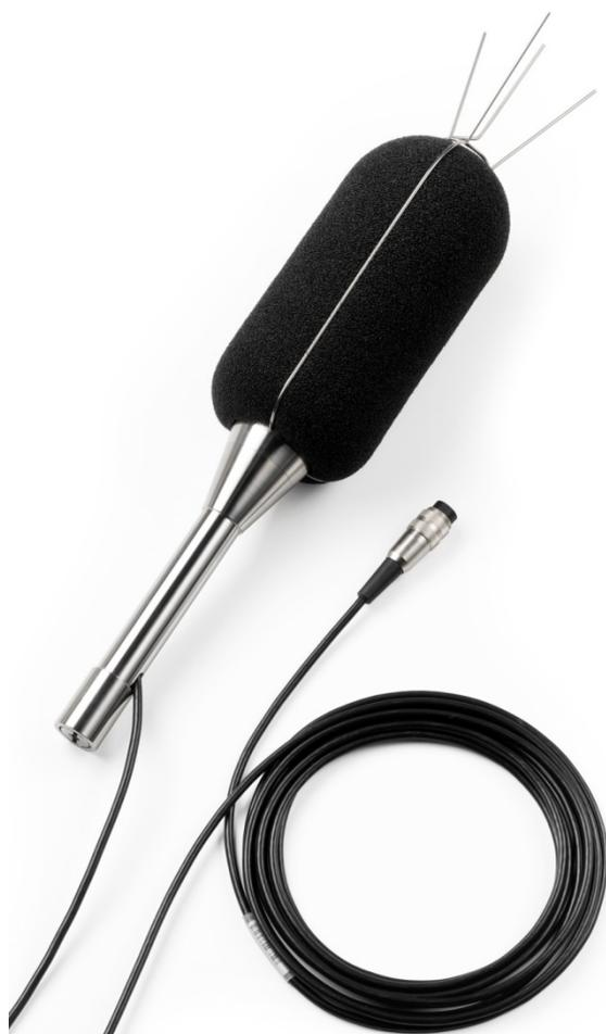
Il preamplificatore dei fonometri Delta Ohm, abbinato all'unità microfonica per esterni, è dotato di un circuito per la calibrazione elettrica della catena preamplificatore - capsula microfonica, che utilizza una tecnica a ripartizione di carica.
