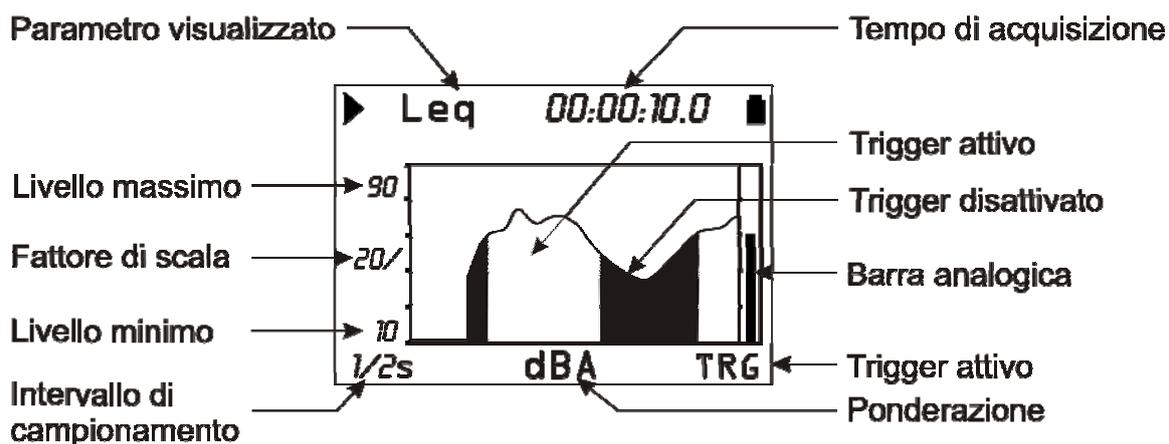
Fig. 27 - Descrizione del display in modalità "Trigger d'evento"
