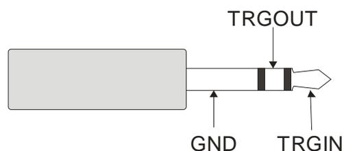
Fig. 1 - Connettore stereo TRIGGER.
