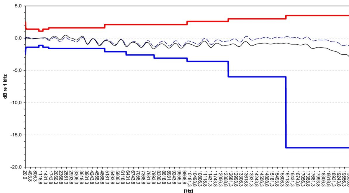
La risposta in frequenza della capsula microfonica dipende dalla presenza di dispositivi come lo schermo anti-vento HD SAV e la protezione per misure in ambiente esterno HD WME.
