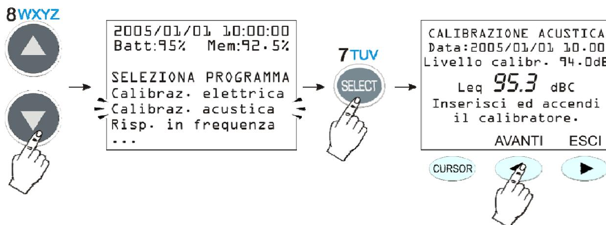
2. La prima schermata riporta la data dell'ultima calibrazione (Data:...) e, nella riga successiva, il livello sonoro del calibratore da usare nella calibrazione in corso (questo valore può essere modificato, prima di avviare il programma di calibrazione, alla voce "Livello Calibratore" del MENU: si veda a pag. 59). Inserire il microfono nella cavità del calibratore e quindi accenderlo.
