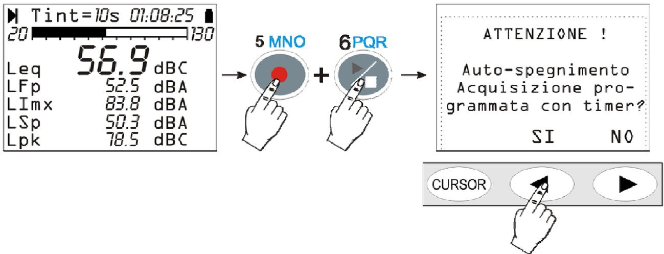
Fig. 32 - Schermata di avviso dell'acquisizione automatica con timer
