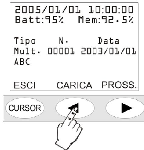
Per ogni file sono indicati, oltre al nome assegnato dall'utente (ABC nell'esempio in figura), il tipo (se singolo, multiplo, automatico o riverbero), il numero progressivo assegnato dallo strumento al momento della memorizzazione e la data. Per passare al file successivo premere il tasto PROSS, per caricare il file corrente premere CARICA. Premendo CARICA, lo strumento torna in visualizzazione standard ed i simboli di STOP e di batteria si alternano alle lettere R (Replay) e P (Programma).
