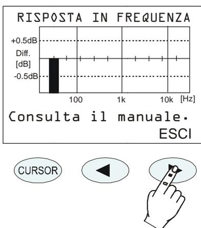
Al termine della procedura viene presentata la differenza della risposta in frequenza del complesso microfono-preamplificatore-strumento rispetto a quella memorizzata precedentemente. Qualora la risposta presenti vistose deviazioni dalla piattezza tali da causare il fallimento della procedura, occorrerà consultare la “Guida alla risoluzione dei problemi” (a pagina 138), ed eventualmente contattare l’assistenza.
