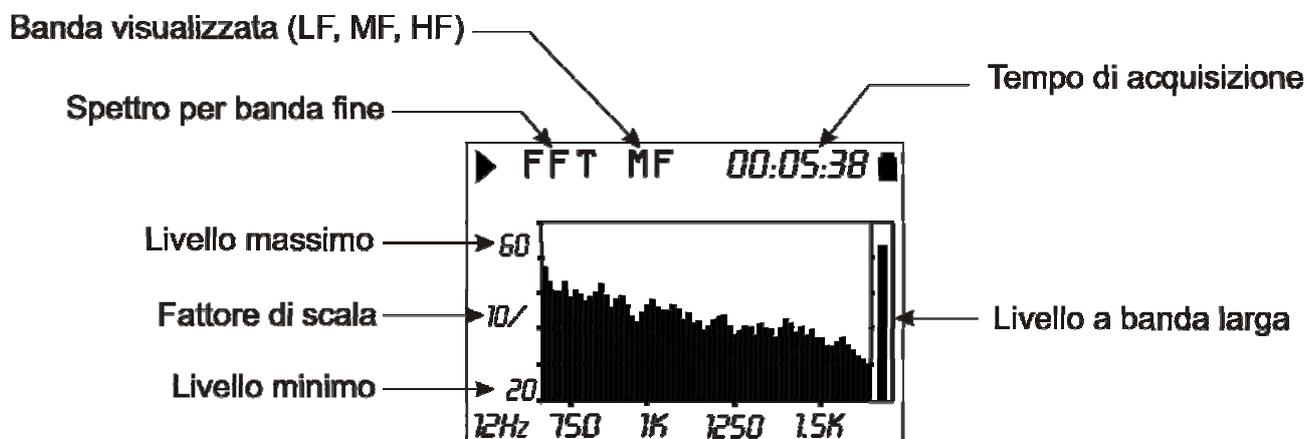
Fig. 23 - Descrizione del display in modalità FFT
