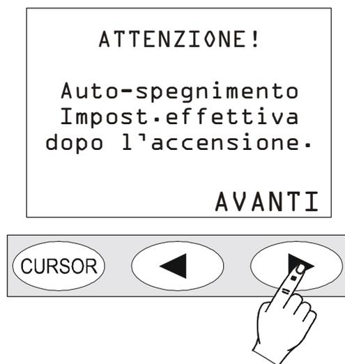
Premendo AVANTI, lo strumento si spegne. Alla successiva riaccensione appare il messaggio che ricorda come i filtri di terzo d'ottava siano temporaneamente stati traslati di mezza banda in basso. Confermare premendo AVANTI. In questa modalità di funzionamento non sono attive le schermate profilo temporale e spettro ad ottave mentre tutte le altre funzioni sono operative. Per ripristinare il normale funzionamento dello strumento, è sufficiente spegnerlo e riaccenderlo.
