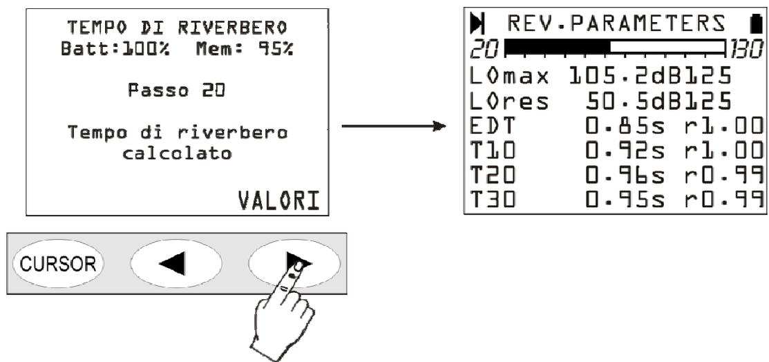
Il fonometro fornisce una descrizione completa della misura appena eseguita sia in forma di tabella che in forma grafica. Si veda più avanti il paragrafo dedicato alla descrizione dell'analisi dei risultati "*Tempo di riverbero - Analisi dei risultati*".
