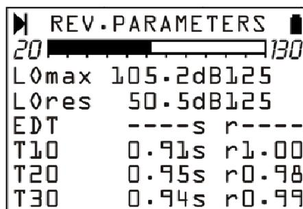
Nella misura del tempo di riverbero con il metodo della sorgente interrotta, il valore EDT non viene calcolato.
