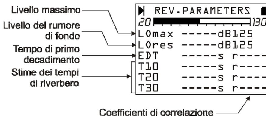
Dall'alto in basso sono riportati: il livello massimo per banda d'ottava raggiunto dalla sorgente di rumore (LO max), il livello del rumore di fondo per banda d'ottava (LO res), il tempo di primo decadimento EDT e le tre stime del tempo di riverbero T<sub>10</sub>, T<sub>20</sub> e T<sub>30</sub> ciascuno con i coefficienti di correlazione "r".
