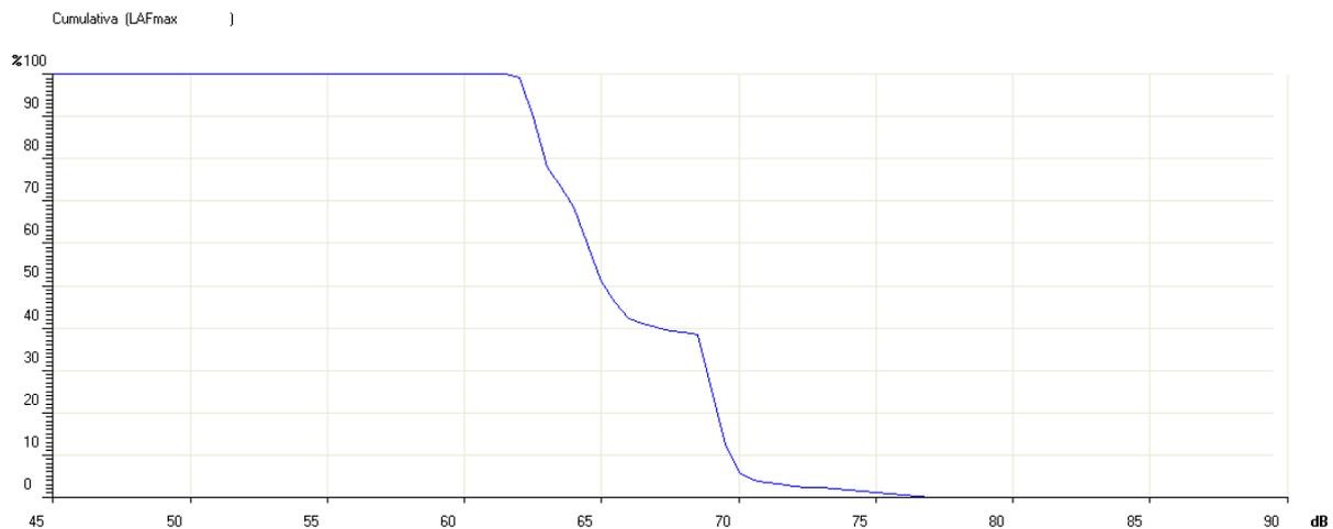
I *livelli percentili* vengono calcolati per interpolazione sulla distribuzione cumulativa. L'analizzatore azzerava le classi all'inizio della misura ed accumula la statistica sino al termine della misura.
