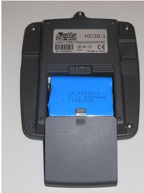
*Figure 2.1: batteria non collegata all'interno del vano batteria.*
