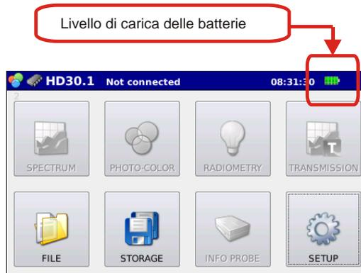
Figura 6.5: Indicazione del livello di carica delle batterie.
