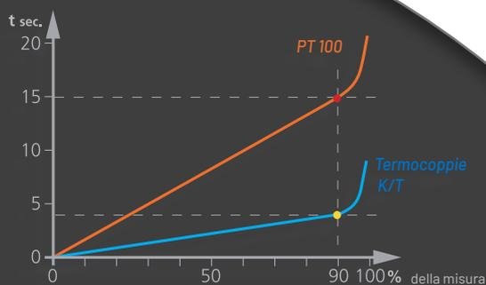
Tempo medio di risposta di una sonda in un liquido.
