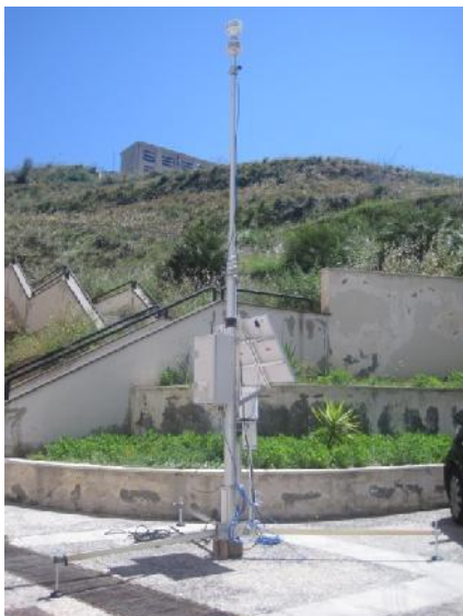
Stazione meteorologica portatile con palo pneumatico leggero h=10m, treppiede pieghevole e anemometro sonico biassiale multiparametrico con bussola integrata
