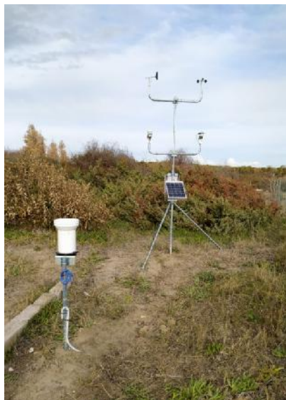
Stazione meteorologica su palo telescopico da 3m (senza opere edili) per il monitoraggio climatico nel golfo di Taranto
