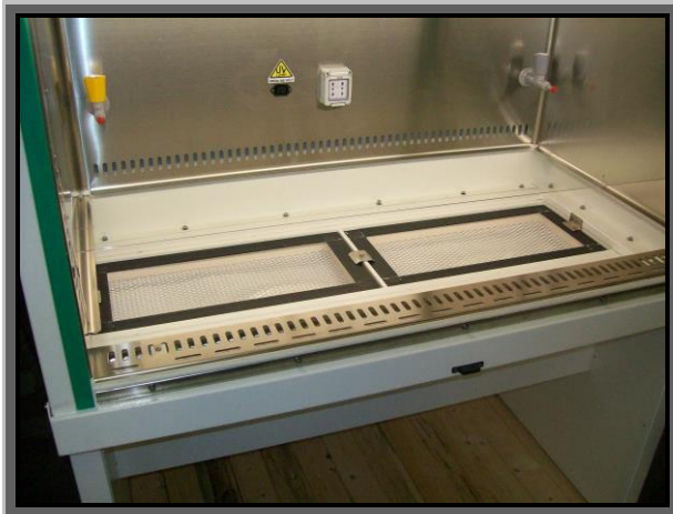
Terzo filtro hepa posto sotto il piano di lavoro
