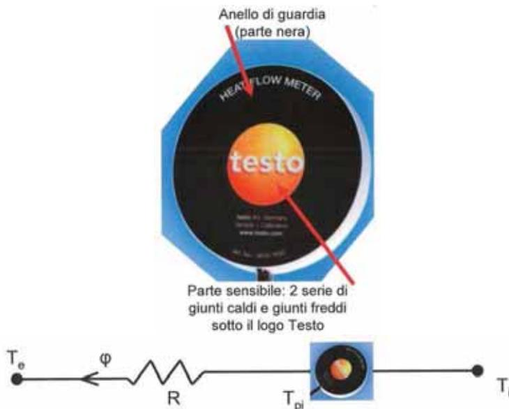
Il flusso viene misurato direttamente dalla piastra termoflussimetrica che utilizza per la misura del flusso l'effetto Seebeck (lo stesso principio fisico delle termocoppie).
