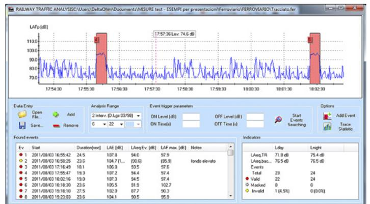
NS2A "Inquinamento Acustico": analisi sulle 24 ore con ricerca automatica dei transiti dei convogli ferroviari.
