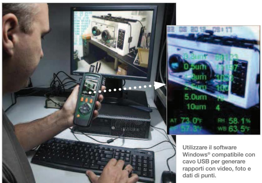
Utilizzare il software Windows® compatibile con cavo USB per generare rapporti con video, foto e dati di punti.
