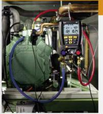
Grazie alle due sonde termometriche collegabili esternamente, testo 550 calcola simultaneamente surriscaldamento e sottoraffreddamento. Per esempio, utilizzando la sonda a nastro per misurare la temperatura sulle tubazioni. Questa sonda, inclusa alla consegna, va posizionata intorno alla tubazione, di cui registra la temperatura di superficie.
