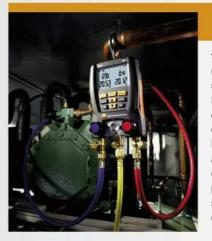
testo 550 visualizza il vuoto raggiunto durante lo svuotamento dell'impianto. Inoltre, il nuovo manifold consente di eseguire la prova di tenuta dell'impianto. Misurando la temperatura ambiente e la pressione dell'impianto in un determinato periodo di tempo, è possibile stabilire la tenuta stagna dell'impianto stesso.
