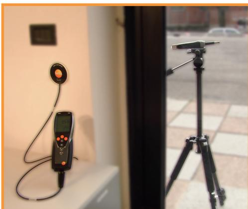
Il valore di trasmittanza termica di un edificio è fondamentale quando si ha la necessità di stimare il fabbisogno energetico e le emissioni di CO<sub>2</sub> per il riscaldamento invernale o il raffreddamento estivo. Il sistema di misura testo prevede uno strumento multifunzione per l'acquisizione dei dati, una sonda wireless e la nuova sonda termoflussimetrica a piastra ad alta sensibilità per la misura del flusso termico.
