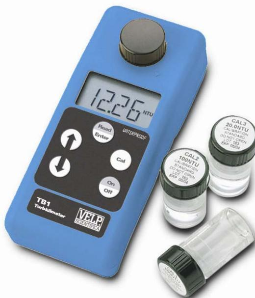
La misura di **torbidità** è uno dei parametri più utilizzati per la determinazione della qualità delle acque. Il valore di torbidità è quindi importante in **campi di applicazione** quali acque potabili, processi di disinfezione, processi industriali e impianti di trattamento delle acque.
