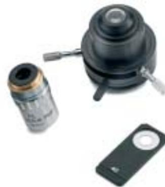
I modelli da 86.410 a 86.491 hanno un set per contrasto di fase Zernike con condensatore di fase A.N. 1.25 e un piano di fase scorrevole contenente un anello di fase ed una apertura per campo chiaro. Completo di un obiettivo di fase piano S40x e obiettivi semi piani 4x, 10x e 100x o piani per campo chiaro.
