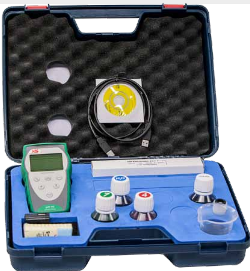
Valigia di trasporto completa di accessori, utile per essere usata come laboratorio portatile
