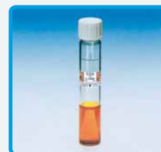
Provetta "pronta all'uso" per analisi COD
