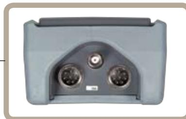
Ingressi per elettrodo pH, cella di conducibilità e elettrodo ossigeno
