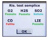
L'uso di un codice cromatico per i caratteri di testo consente di vedere e interpretare i risultati dei test o della calibrazione a colpo d'occhio.
