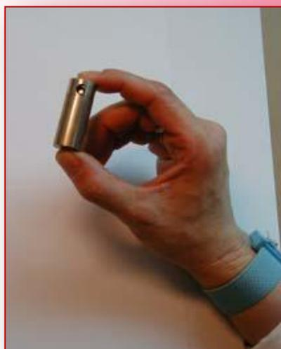
Il logger MiniVacq è stato ideato per il monitoraggio dei processi di pastorizzazione. Il range di misura differisce dal modello Picovacq in quanto ha come temperatura massima raggiungibile i 100°C
