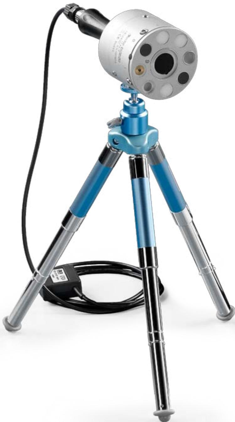
Tramite il **software DeltaLog13 dalla versione 1.0.1.0** e un PC, **HD2402** può essere configurato (calendario, data, ora, istante di partenza e durata del logging) ed è possibile effettuare lo scarico e l'analisi dei dati memorizzati e l'acquisizione dei dati in tempo reale. Una volta configurato, il datalogger può essere scollegato dal PC e collegato al suo alimentatore per l'acquisizione e la memorizzazione dei dati secondo le impostazioni programmate.
