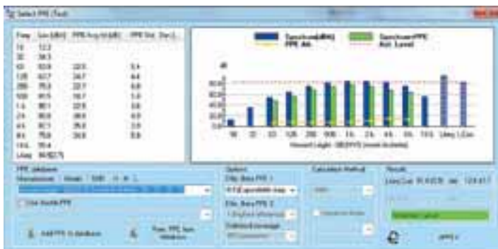
NS1 "Protezione Lavoratori": analisi dell'efficacia del DPI.
