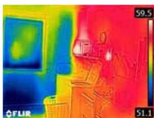
Parete esterna non isolata
