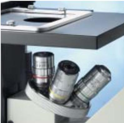
Revolver in un microscopio invertito
