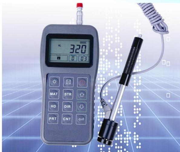
Il Durometro Digitale Portatile ZL180 è uno strumento in grado di misurare le durezze attraverso il sistema di misura ad impatto. Si possono misurare le seguenti scale di durezza HRB,HRC,HV,HB,HS,HLD e anche il carico di rottura. La sonda può essere posizionata in qualsiasi direzione grazie ad un sistema automatico di compensazione.
