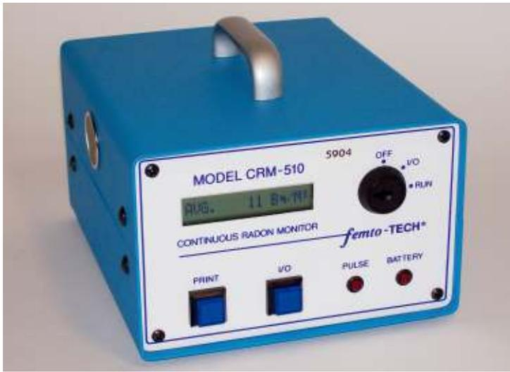
Il monitor Femto-Tech CRM-510 è uno strumento portatile per la misurazione della concentrazione del gas radon in aria.
