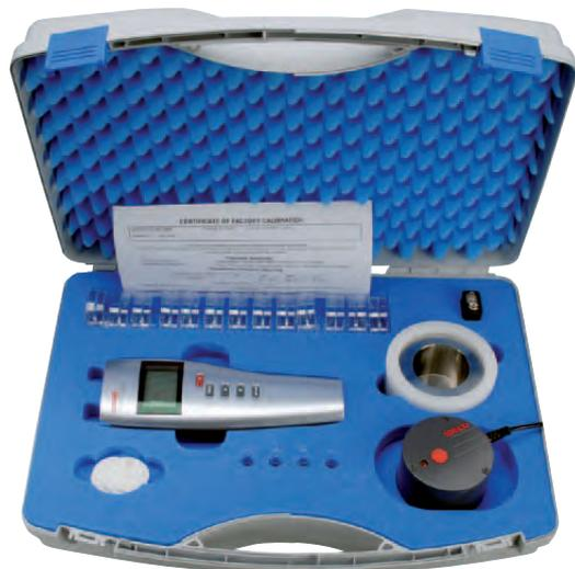
Il set AW è la soluzione perfetta per effettuare le misure direttamente in loco. Fornito in una leggera e resistente valigetta in ABS, contiene tutto il materiale necessario per la misurazione e la calibrazione.
