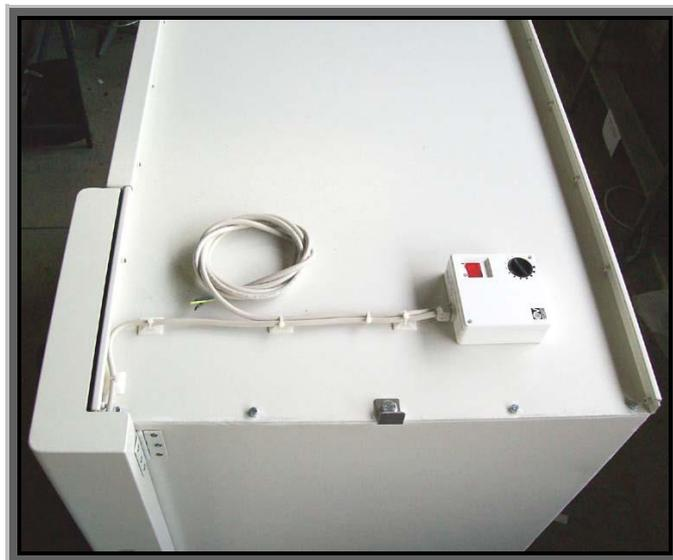
Interruttore e regolatore di velocità per ventilatore di espulsione supplementare, posizionati sul tetto della cappa.
