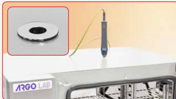
Il sensore PT100 installato all'interno della camera garantisce il controllo preciso della temperatura. Tutti gli strumenti sono comunque forniti di un foro passante del diametro di 5 mm per poter installare all'interno della camera uno o più sensori per la verifica della temperatura.
