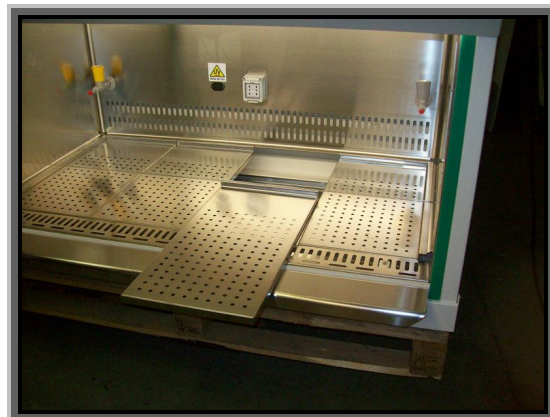
Piani di lavoro forati removibili e autoclavabili con vasca di raccolta liquidi sottostante
