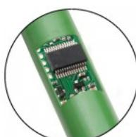
**Elettrodi digitali** – il collegamento degli elettrodi non è mai stato così pratico, veloce e sicuro. Tutte le sonde sono dotate di connettore digitale mini-jack da 3.5 mm. Ciò rende davvero semplice la sostituzione del sensore, quando si passa dalla misura di pH, EC o DO ad un altro parametro.
