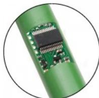
**Elettrodi digitali** – il collegamento degli elettrodi non è mai stato così pratico, veloce e sicuro. Tutte le sonde di misura sono dotate di connettore digitale mini-jack da 3.5 mm. Ciò rende davvero semplice la sostituzione del sensore, quando si vuole passare dalla misura di pH, EC o DO ad un altro parametro.
