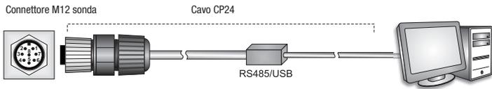
B. Utilizzando la presa volante M12 a 8 poli fornita o il cavo **CPM12-8D...** opzionale e un convertitore RS485/USB o RS485/RS232 generico. In questa modalità di connessione è necessario alimentare separatamente la sonda. Se si utilizza un convertitore RS485/USB è necessario installare nel PC i driver USB relativi.
