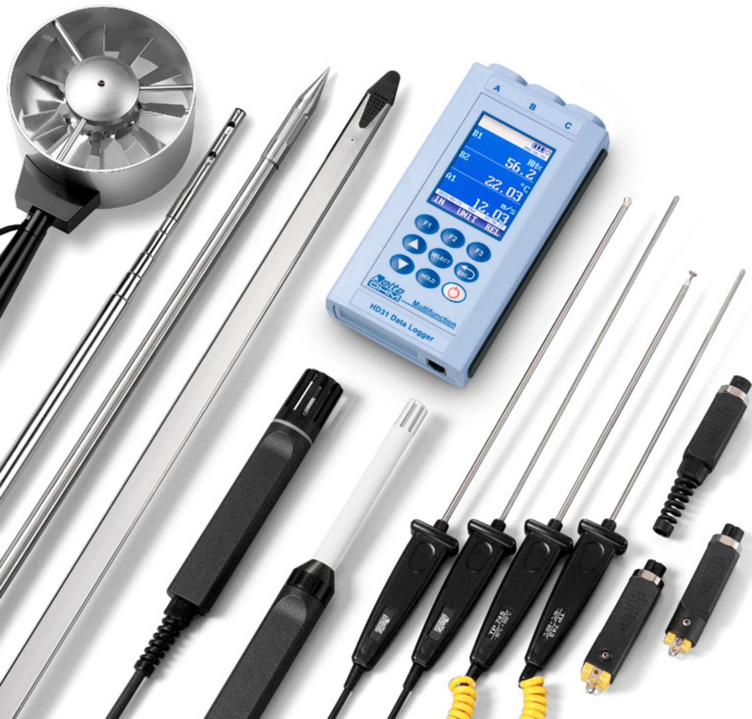
Batteria ricaricabile agli ioni di litio. Spegnimento automatico (disattivabile) dopo un tempo di inattività configurabile dall'utente (2, 5, 10, 15, 20 o 30 minuti) per preservare la carica della batteria. Alimentazione esterna tramite l'ingresso USB (con connettore mini-USB) collegando un alimentatore da 5 Vdc o la porta USB (da almeno 500 mA) di un PC. Con alimentazione esterna collegata, la batteria viene ricaricata e lo spegnimento automatico si disattiva automaticamente.
