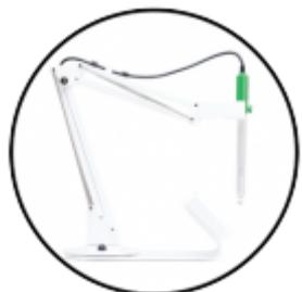
**Supporto da banco multifunzione** – Il supporto da banco in dotazione funziona anche da stazione di calibrazione portatile elettrodostatico porta elettrodo con braccio girevole.
