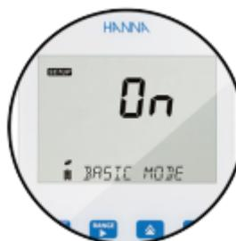
**Messaggi guida** – edge™ visualizza chiari e complete messaggi di guida sulla parte bassa del display. Per decifrare strane abbreviazioni; queste utili indicazioni vi guideranno attraverso il processo di misura e calibrazione veloce e semplice.
