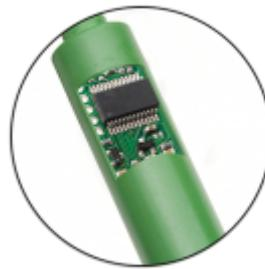
**Elettrodi digitali** – il collegamento degli elettrodi non è mai stato così pratico, veloce e sicuro. Tutte le sonda sono dotate di connettore digitale mini-jack da 3.5 mm. Ciò rende davvero semplice la sostituzione del sensore e la possibilità di passare dalla misura di pH, EC o DO ad un altro parametro.
