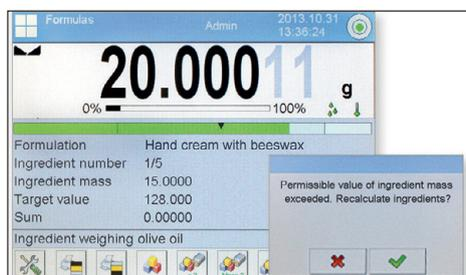
**Comoda composizione di miscele:** È possibile memorizzare miscele complete con tutti i relativi componenti ed i corrispondenti valori nominali, nomi, tolleranze, pesi di tara ecc. La pratica regolazione della ricetta in caso di sovradosaggio di un suo componente ricalcola automaticamente i nuovi pesi nominali degli altri componenti della ricetta in presenza di un ingrediente con peso eccessivo.
