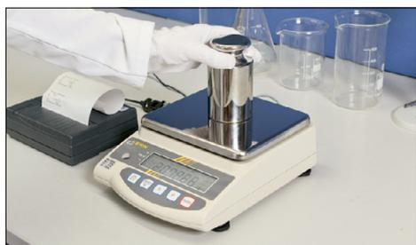
**Messa a protocollo secondo le norme GLP/ISO** dei dati di pesata, di calibrazione di bilancia ecc. con data, ora e numero di identificazione. Ideale per monitorare e documentare i processi secondo il sistema di gestione qualità in uso
