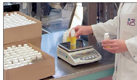
**Pesata con valori di tolleranza (checkweighing):** un segnale ottico supporta il lavoro di porzionatura, dosaggio o assortimento
