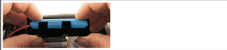
6. Inserire la nuova batteria nel vano. Accertarsi che il cavo del connettore fuoriesca lateralmente dal vano. Spingere la batteria nel vano sino allo scatto in sede dei fermagli.
