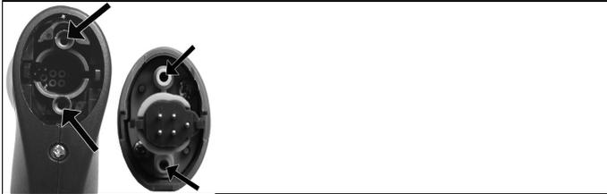
2. Soffiare aria compressa nei condotti del modulo e dell'impugnatura (v. figura). Non utilizzare spazzole!
