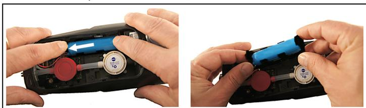
3. Premere leggermente il vano batterie con le dita. Tirare il fermaglio in direzione della freccia sino a quando l'arresto si apre. Sfilare il vano.
