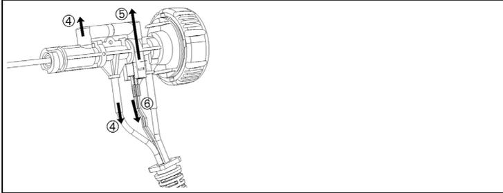
4. Staccare l'adattatore (4) e il flessibile (5), sfilare la termocoppia dal supporto e staccare il cavo (6) dalla termocoppia.
