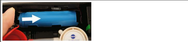
8. Sistemare il vano sulla rotaia di guida e spingerlo in direzione della freccia sino a quando scatta percettibilmente in sede.
