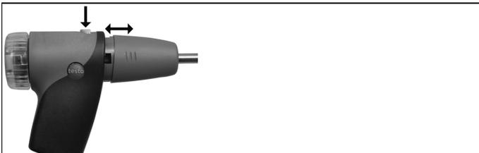
1. Azionare il tasto nella parte superiore dell'impugnatura della sonda e staccare il modulo.
