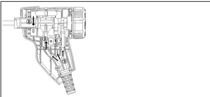
6. Collegare l'adattatore e il flessibile alla termocoppia (8). Sistemare i cavi e i flessibili (9), rimontare gli inserti dei semigusci.
