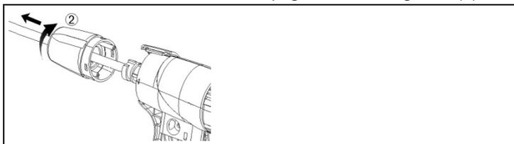
2. Ruotare il tappo di chiusura (2) in senso orario sino all'arresto e rimuovere il tubo della sonda.
