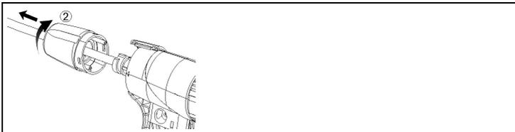
2. Ruotare il tappo di chiusura (2) in senso orario sino all'arresto e rimuovere il tubo della sonda.
