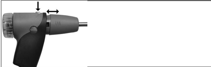
1. Sganciare la sicura della sonda premendo l'apposito tasto situato sull'impugnatura e rimuovere il modulo della sonda.
