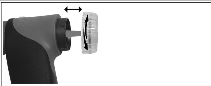
1. Aprire la camera del filtro: ruotare delicatamente in senso antiorario.
