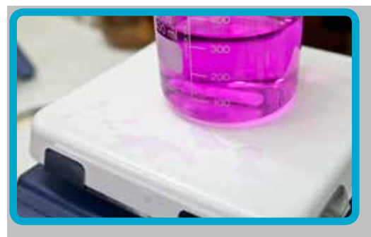
Piattello in vetroceramica a elevata resistenza chimica
