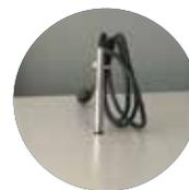
Foro di calibrazione sul lato superiore per inserimento termometro o sonde
